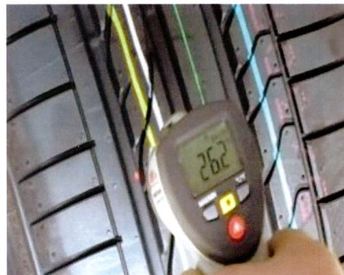
*Im Tiretherm erwärmt sich der Reifen in nur wenigen Minuten auf 24 bis 27 Grad Celsius.*
