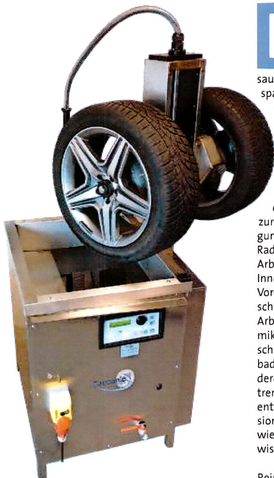
Die RW 302 Twin reinigt die Räder in einem Wasserbad mit einem speziellen Ultraschall-Verfahren. Foto: Tiresonic
